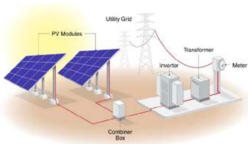
Рис. 2-4 Иллюстрация конфигурации фотоэлектрических станций общего пользования
